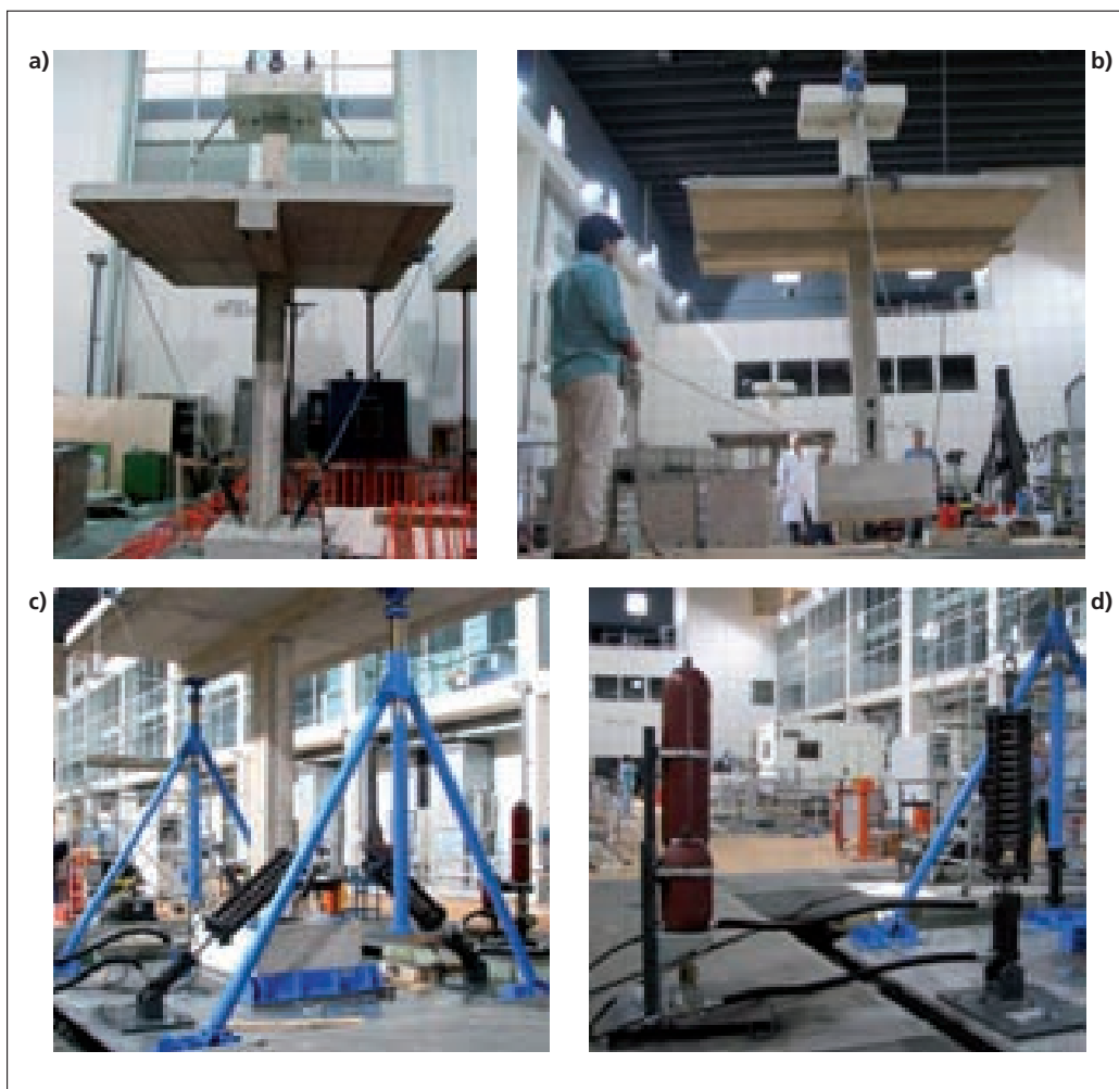
Figura 12. Il modello ed il sistema di vincoli metallici.
